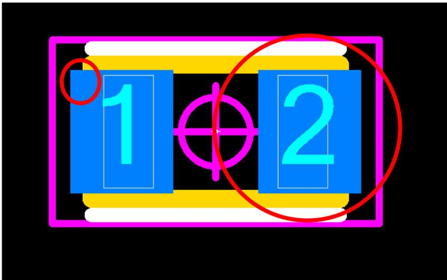
NOTICE HOW THE PAD SHAPE AND SOLDER MASK EXPANSION USER PREFERENCES ARE LOST!!!
